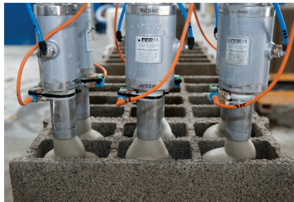
Inaugurée en novembre 2016, la nouvelle ligne de production, spécialement conçue pour remplir les blocs KOSMO CITY d'Alkern de mousse Airium™ Lafarge, est la première installation en France.
